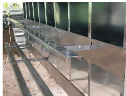
DETALLE DE LA INSTALACION DE LAS BISAGRAS Y PERCHAS
